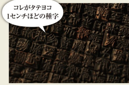
本木昌造が作り出した電胎法による日本初の種字
